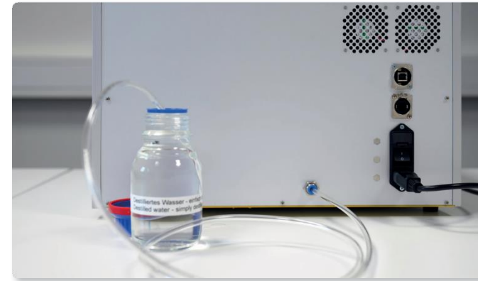
Illustration : Côté arrière de l'Huminator II avec tuyau connecté pour le remplissage du système
