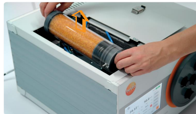
Illustration : Retirer la cartouche de desiccant
