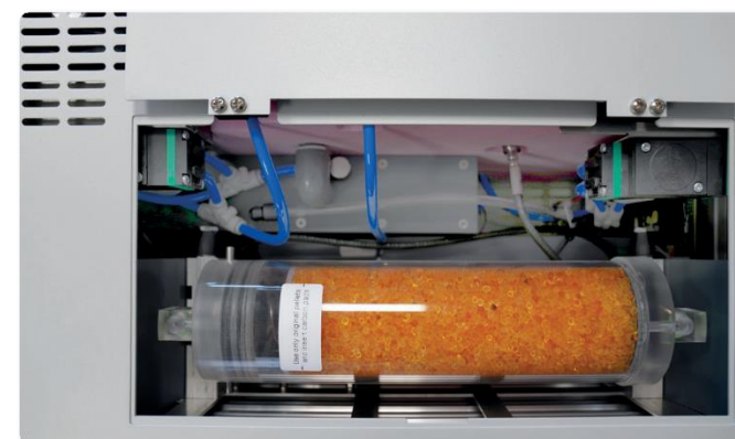
Illustration : Cartouche sèche utilisée dans l'Huminator II
