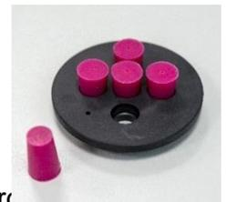
Le couvercle de travail est vissé sur le micro-bain et comporte cinq ouvertures pour les spécimens de test. Les ouvertures non utilisées peuvent être fermées avec des bouchons en silicone appropriés.
